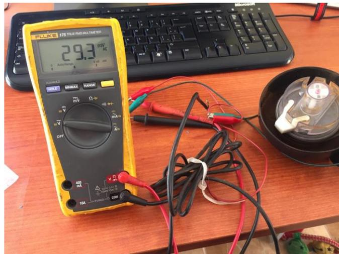
*Figura 21. Medición del cableado del medidor de caudal*
