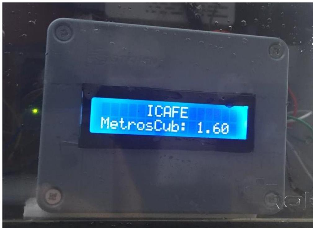
*Figura 60. Visualización de los metros cúbicos desde el display LCD*
