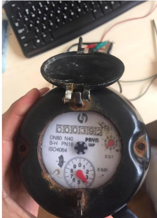
Figura 29. Agujas del medidor
