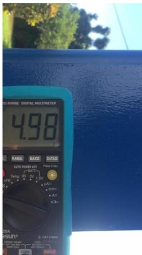
*Figura 73. Medición del voltaje cuando el circuito pull-up emite el pulso*
