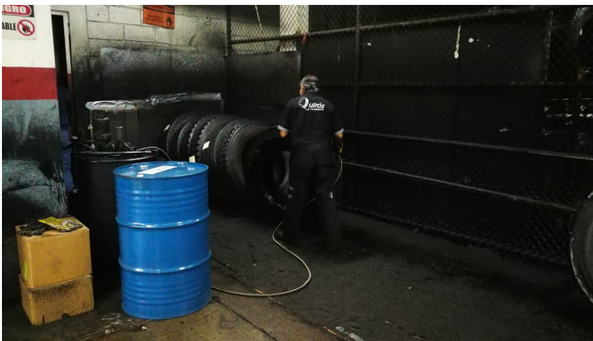
Figura 21. Proceso Manual Pintado de llantas
