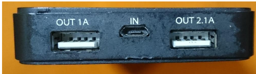
Imágene 27 Bateria externa V-Dimension entradas y salidas
