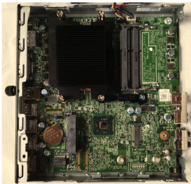
Figura 43: Colocación de la tarjeta madre dentro del case.
