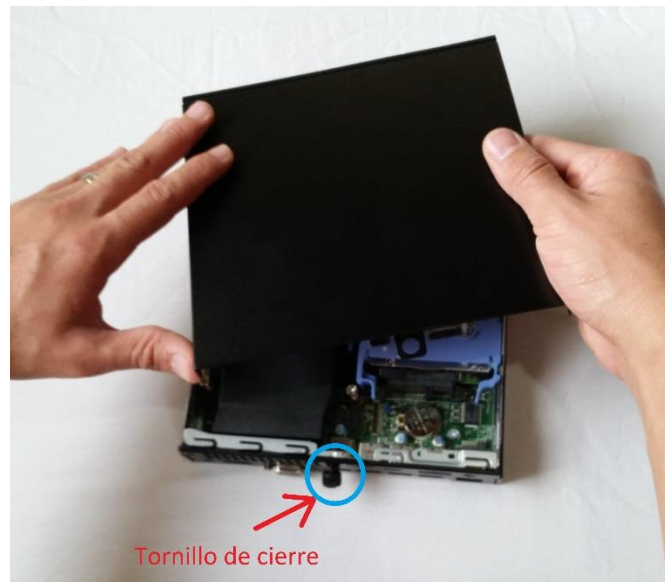
Figura 47: Cierre del case con los componentes instalados.
