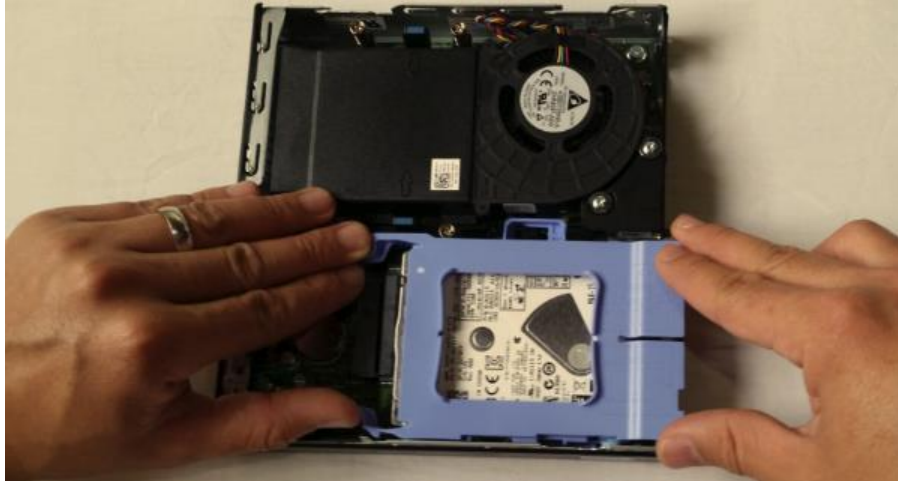
Figura 46: Colocación del disco duro en la tarjeta madre.
