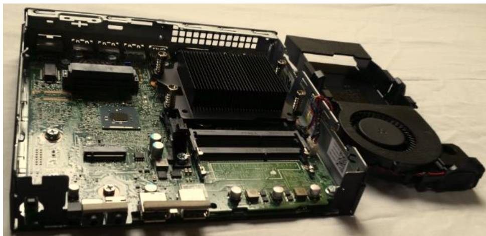
Figura 44: Colocación del microprocesador en la tarjeta madre.
