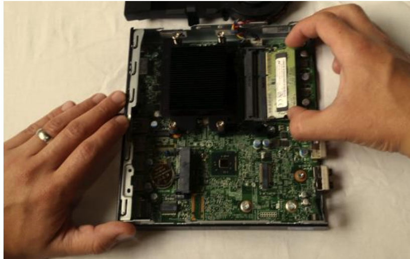
Figura 45: Colocación de la tarjeta de memoria RAM en la tarjeta madre.
