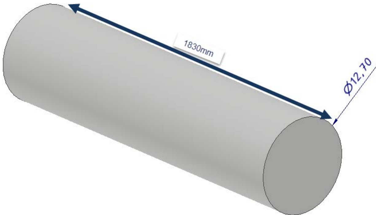
Figura 16. Sólido de la barra de cromo cobalto representada con medidas exactas.
