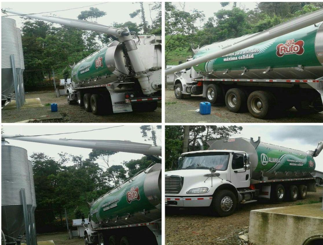
Figura 66: Sistema de Descarga de Chompipa a Silo de almacenamiento.
