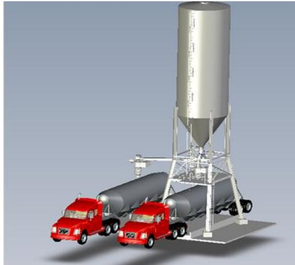
**Figura 19: Ejemplo para carga por gravedad para camiones**
