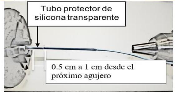
**NOTA:** Reemplace el sub-ensamble de la banda si el alambre conductor se desprende de la banda durante el proceso de tiraje de la banda.
