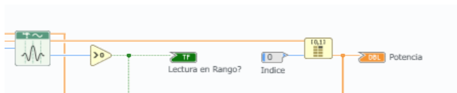
Figura 34. Conjunto de funciones para obtener el pico de potencia. Fuente: creación propia.
