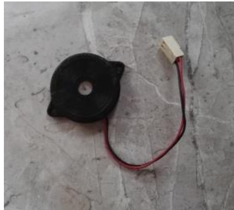
Imagen 11: Buzzer del Connect
