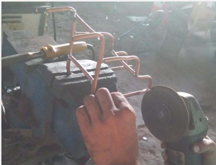
**Figura 19** Corte de partes y afinado de puntas
