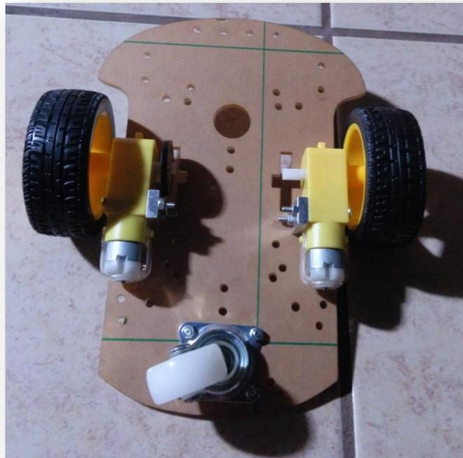
Figura 21 Vista inferior instalacion de motores
