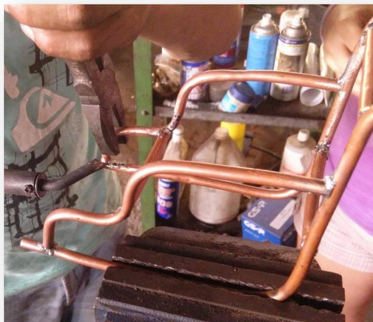
Figura 17 Soldado de partes del armazón
