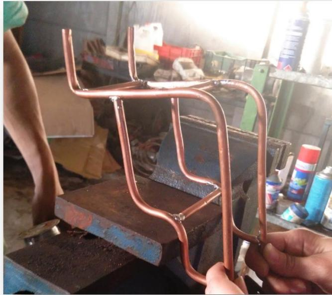
**Figura 18** Revisión y enfriamiento de los puntos
