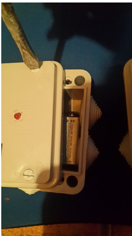
Ilustración 53: Retiro de tornillos y vista de la batería
