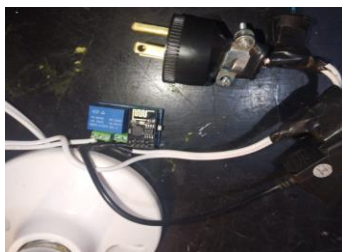
Figura 42 ESP 01-s Módulo RELAY
