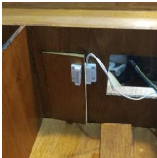
Figura 73 Sensor de acceso de puerta trasera
