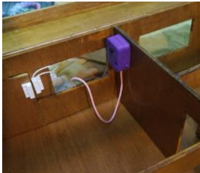
Figura 71 Sensor de puerta y Cámara
