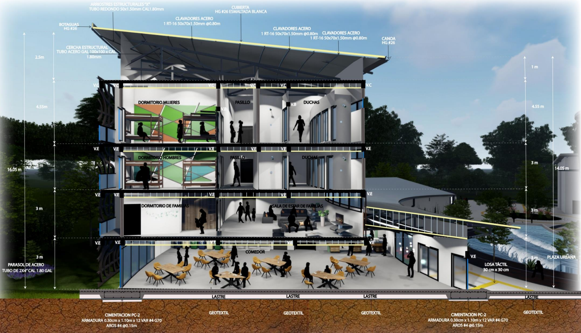
Ilustración 170: Corte Arquitectónico Edificio Dormitorios. Fuente: Elaboración propia.
