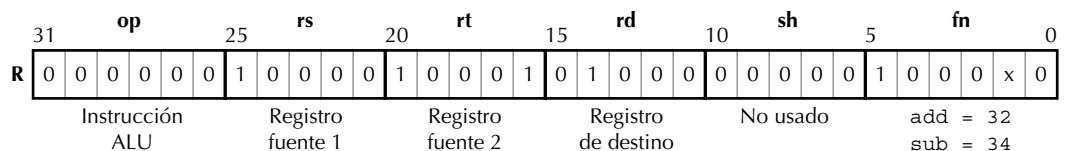
Figura 5.5 Las instrucciones aritméticas add y sub tienen un formato que es común a todas las instrucciones ALU de dos operandos. Por esto, el campo fn especifica la operación aritmética/lógica a realizar.
