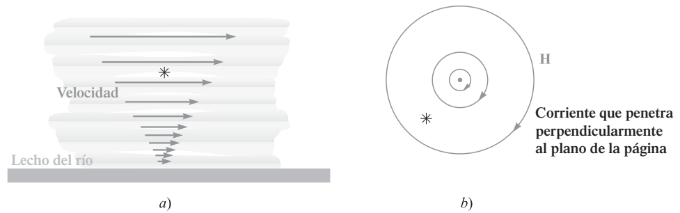
Figura 7.14 a) El medidor de rotacional muestra una componente del rotacional de la velocidad del agua hacia adentro de la página. b) Se muestra el rotacional de la intensidad de campo magnético alrededor del filamento de longitud infinita.
