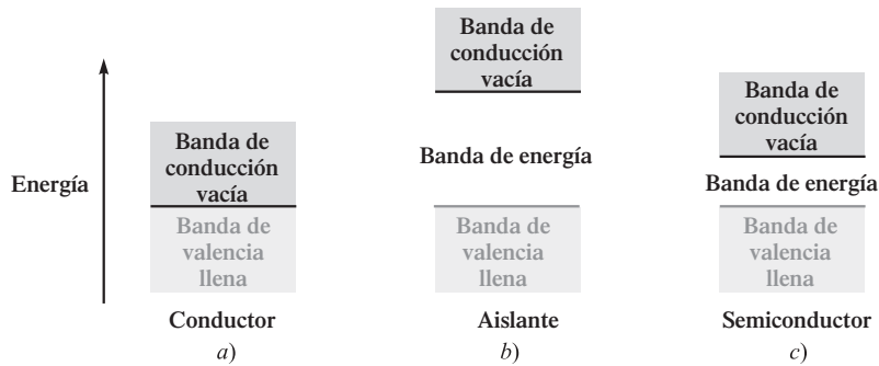
Figura 5.2 Estructura de bandas de energía en tres diferentes tipos de materiales a 0^\circ \text{K} . a) El conductor no presenta una brecha de energía entre las bandas de valencia y conducción. b) El aislante tiene una gran brecha de energía. c) El semiconductor tiene solamente una pequeña brecha de energía.
