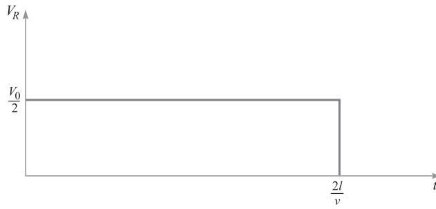
Figura 10.27 Voltaje en una resistencia en función del tiempo, como se determinó en el diagrama de reflexión de la figura 10.26, en el que R_g = Z_0 ( \Gamma = 0 ).
