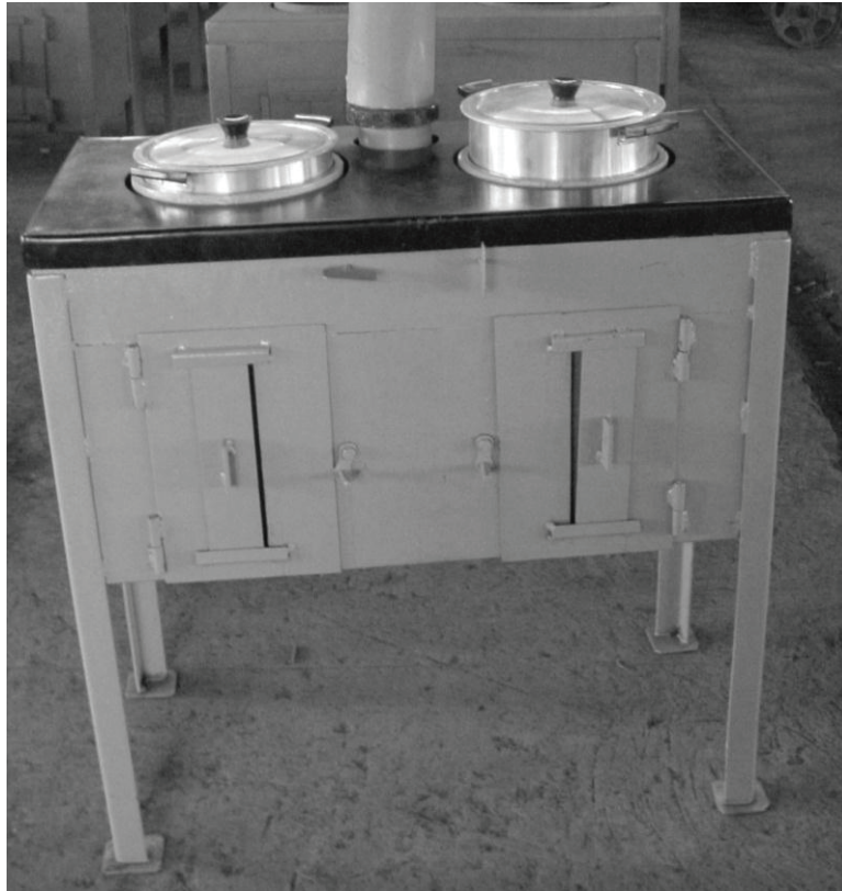
Figura 10.3. Prototipo inicial del fogón eficiente para biomasa.
