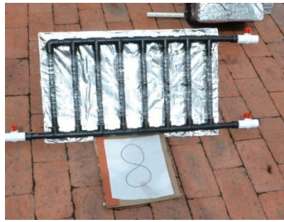
Figura 4. Representación de un calentador solar de agua típico fabricado por los estudiantes en el reto caliente
