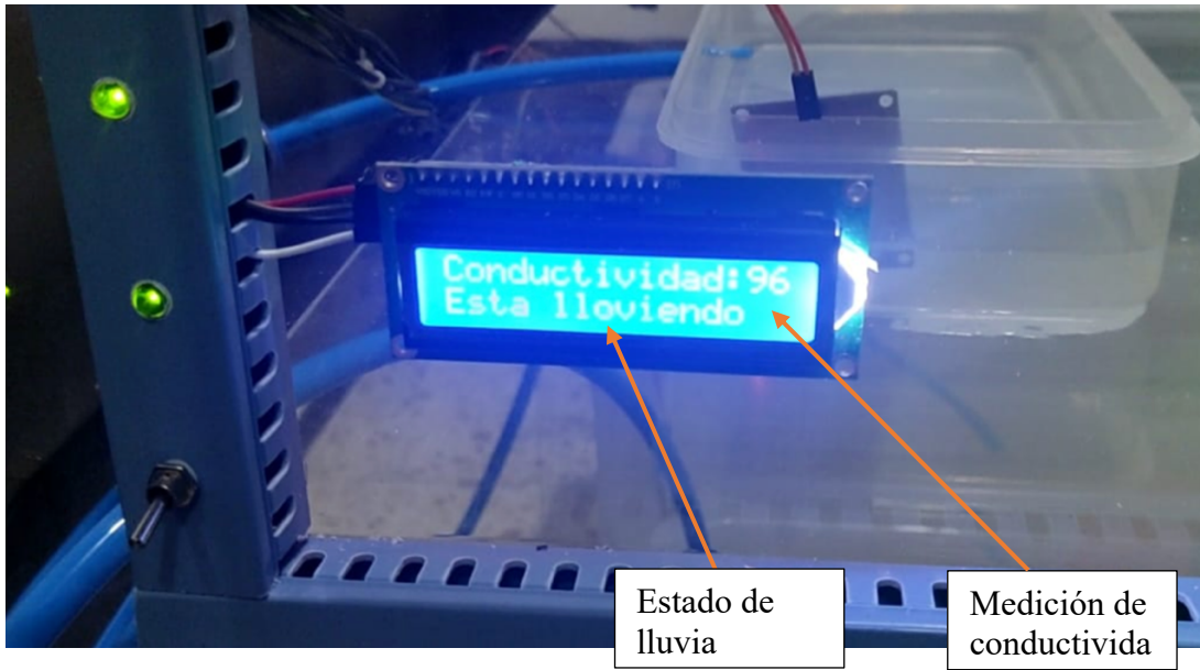
Ilustración 64 Prueba 2 Sensores de conductividad y estado de lluvia
