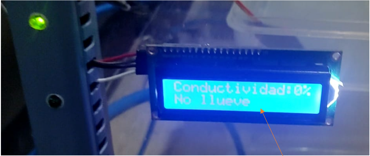
Ilustración 59 Prueba 1 Conductividad y estado de lluvia Fuente Elaboración propia
