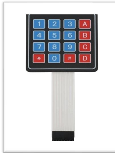
Figura 13. Teclado Membrana Matriz 4X4
