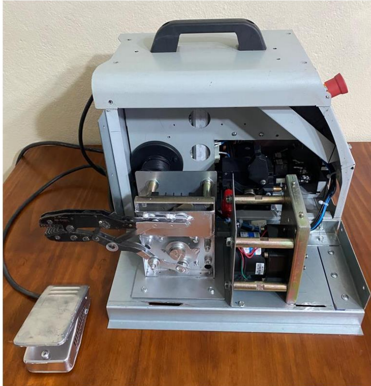
Figura 39. Conexión y ensamble de los mecanismos de corte-pelado, transporte de cable y crimpadora según diagramas de conexión.
