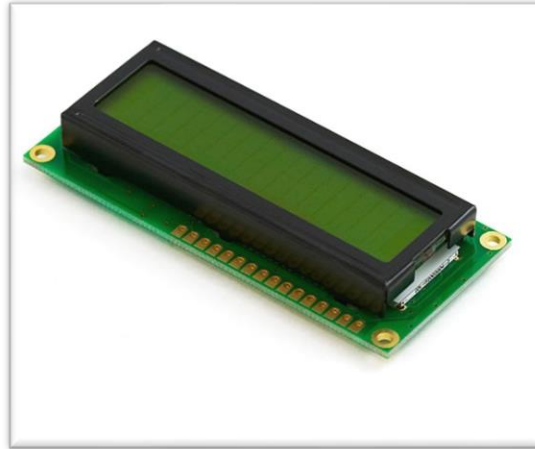
Figura 12. Pantalla LCD-I2C de 16 caracteres
