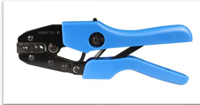
Figura 30. Crimpadora convencional para terminales de pin hueco de 0.75 \text{ mm}^2
