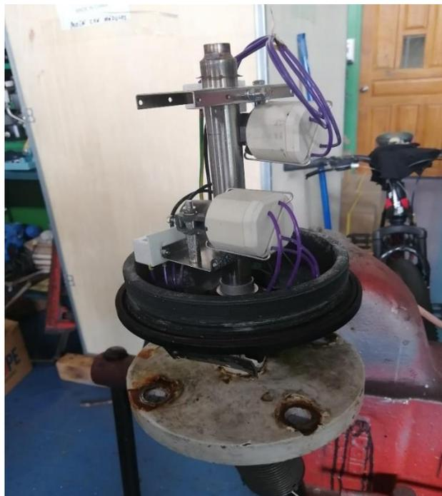
*Ilustración 27- Conexiones del interruptor magnético Morbey.*
