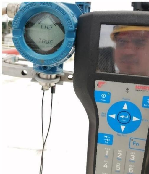
*Ilustración 58- Cambio de configuración, transmisor discreto 702.*
