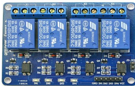
Figura 24: Módulo relés de cuatro canales.
