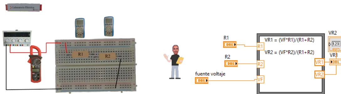
Figura 10. Practica de laboratorio virtual: a) Circuitos divisores de voltaje, interfaz de usuario, b) modelamiento y programación de las ecuaciones
